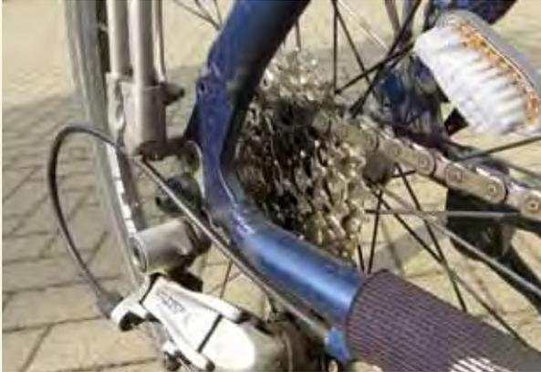
Kettenschaltung aber darin, dass nicht im Stand geschaltet werden kann und auch ein schneller Gangwechsel nicht möglich ist. Das ist im Rad-rennsport auch nicht erforderlich, da geht es nur ums Gewicht und Tempo. Der Alltagsradler, der häufig schalten muss, ist mit einer Nabenschaltung besser bedient. Wer gerne das sportliche Radeln mag, der schmückt sich besser mit vielen glänzenden Ritzeln. /Em
